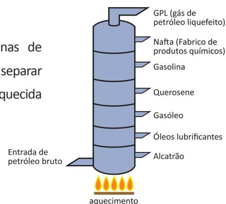
Figura 9 – Destilação do petróleo. Os componentes mais voláteis são retirados na parte mais alta da torre de destilação.
