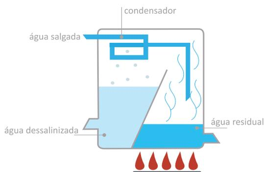
Figura 8 - Destilação simples: esquema de equipamento para destilar água do mar.
